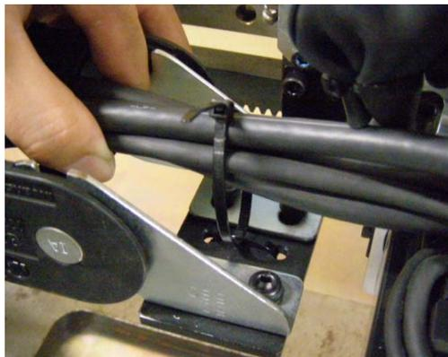
L軸のモーターケーブルとエンコーダケーブルのコネクタ部をシート等で包み、ケーブルベヤ取付けステイに結束バンド等で固定します。
