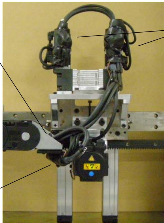
Z軸のモーターケーブルとエンコーダケーブルのコネクタ部をシート等で包み、Z軸モータの側面に結束バンド等で固定します。
