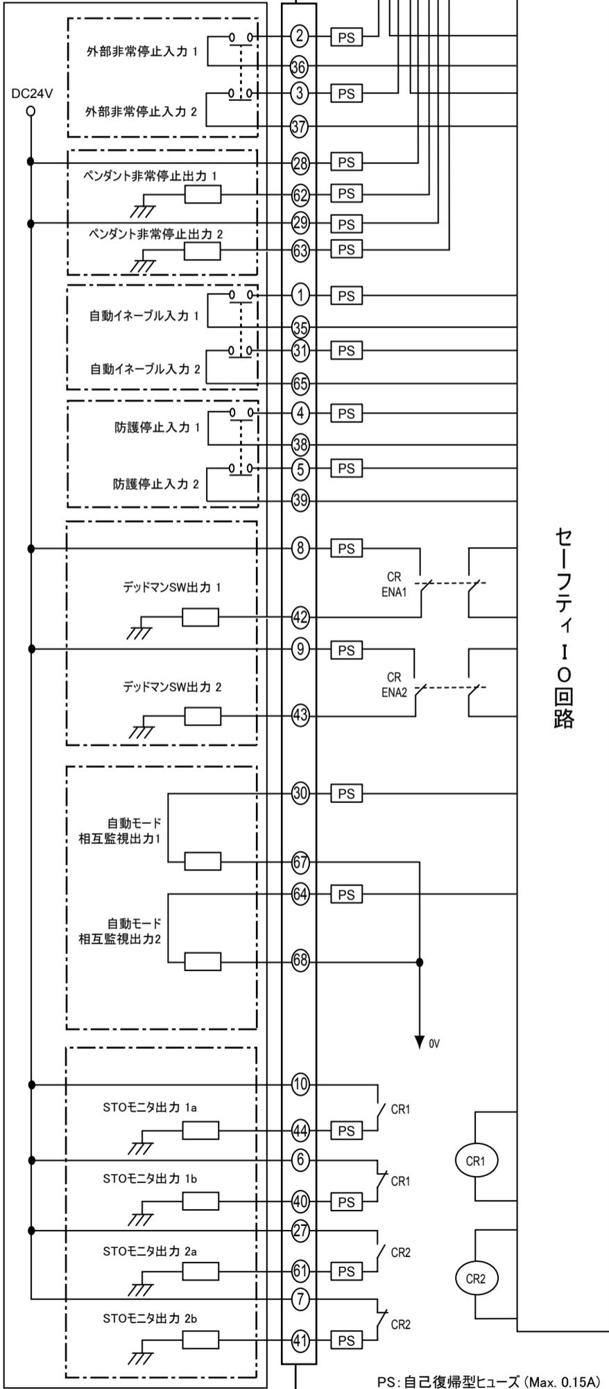
セーフティ/O回路 動作概要(動力遮断動作条件)
