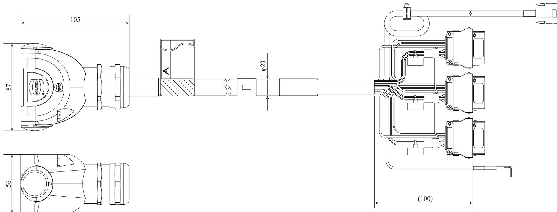
本体間ケーブルの曲げ R (内径) はケーブル固定状態で 33.8 mm 以上、ケーブルが可動する状態では 225 mm 以上を確保してください。過度の曲げは断線の原因となります。
